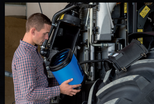
Proporcionālais dzesēšanas sistēmas elementu izvietoējums nodrošina vieglu piekļuvi un ērtu tīrīšanu un apkopes veikšanu. 90 % putekļu tiek iztīrīti dabīgā veidā, pateicoties dzesēšanas ventilatora sūcēj spēkam. Arī motora gaisa filtrs ir viegli pieejams un tīrāms.
