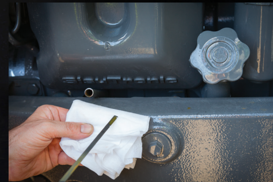
Sašaurinātā motora pārsega un priekšējā tilta konstrukcija nodrošina ērtu piekļuvi motoreļļas filtriem un motoreļļas līmeņa mērstienim.
