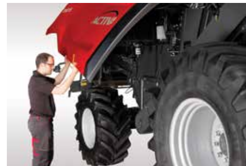
Viengabalaini paneli ar gaismām nodrošina ātru piekļuvi pārbaudes veikšanai
