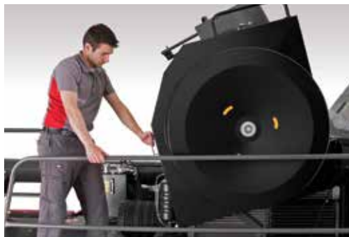
Droša un viegla piekļuve radiatora tīrīšanai
