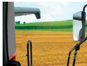
Labi redzams iztukšošanas gliemežtransportieris darba laikā
