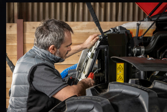
Dzesēšanas sistēmas elementi ir viegli pieejami, kas atvieglo un paātrina tīrīšanu.
